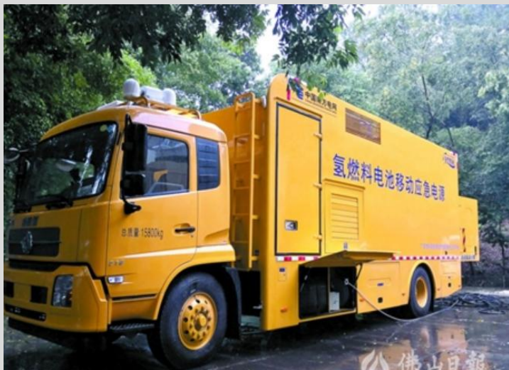
南网氢燃料电池发电应急电源项目 （车载发电系统）
