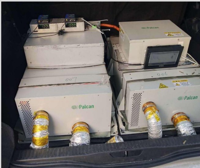
甲醇重整制氢系统发电项目 （车载或船载系统）
