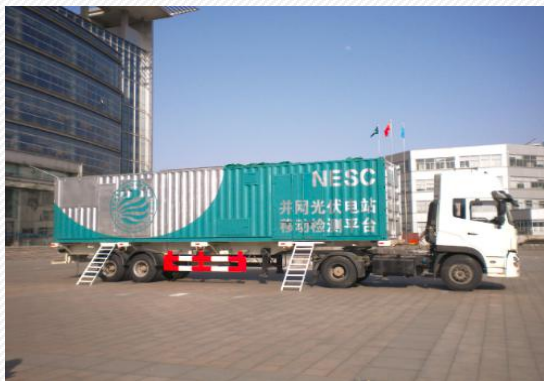
分布式光伏发电系统移动检测平台
