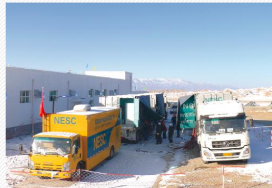
高海拔光伏电站移动式并网性能检测平台
